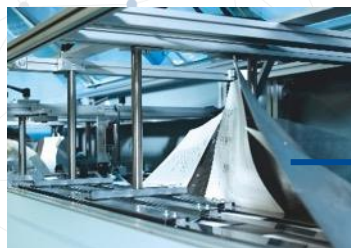
Integrierte Buchblockleimvorrichtung automatisches und sauberes Punktleimsystem
