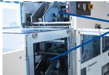
Gefaltzte Signaturen im FB6 werden nachfolgender Sternradauslage zugeführt
