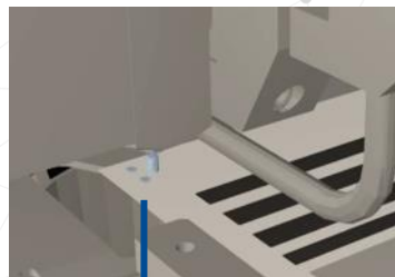
Integrierte Buchblockleimvorrichtung automatisches und sauberes Punktleimsystem
