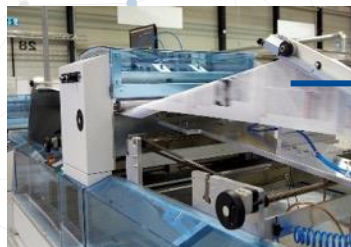
Integrierte Buchblockleimvorrichtung automatisches und sauberes Punktleimsystem
